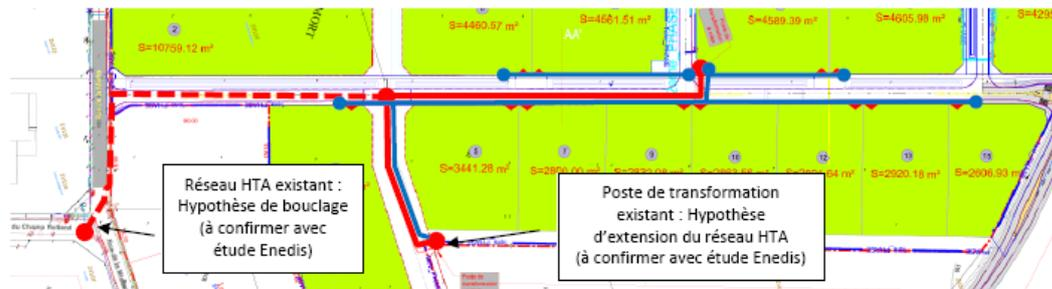
Figure 17 : Schéma de déploiement du réseau HTA et BT – Phase 1
